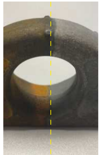
Sans ZD (Sans protection contre la corrosion). Avec ZD (protection cathodique contre la corrosion).
